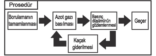
Hava sızdırmazlık prosedürü
